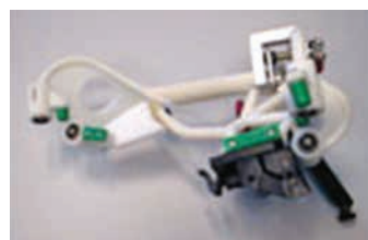
Dieses Werkzeug für die Montage von Stoßfängerhalterungen wurde mit Direct Digital Manufacturing hergestellt.
