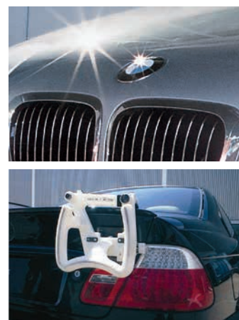
Die Abteilung für Montage- und Halterungswerkzeuge der BMW AG in Regensburg verwendet ein Fortus-System zur Herstellung von Montagewerkzeugen. Mit diesem Werkzeug wird der rückseitige Namenschriftzug befestigt.
